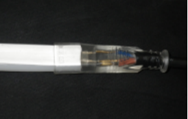
▲ 電源コード等の接続部とフレックスダブルライトに接続したハリの位置を確認し差し込みます。 コーキング剤等で防水処理を施します。
