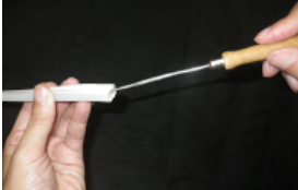
▲ 千枚通し等でワイヤー部分に差し込み穴を広げればピンが刺さりやすくなります。
