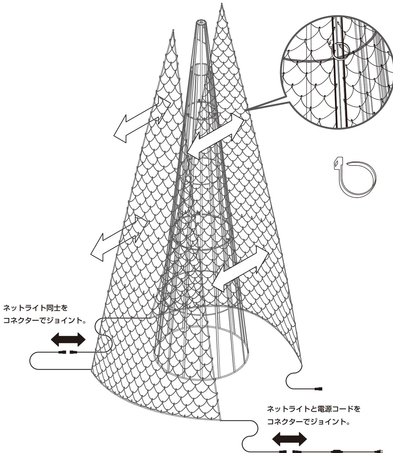
次にストレッチネット（頭巾状縫製済メッシュ生地）をコーンフレームの上から被せます。下方は巾着状の紐が縫い込まれていますので、紐を引っ張って調整します。生地は繊細なため、「破れ」、「裂け」などに十分ご注意ください。
