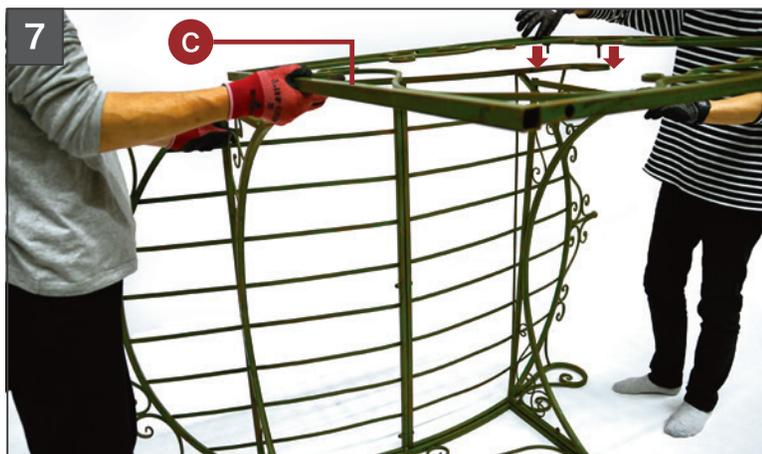
上部に③を取り付けて、ボルトとナットで固定します。
