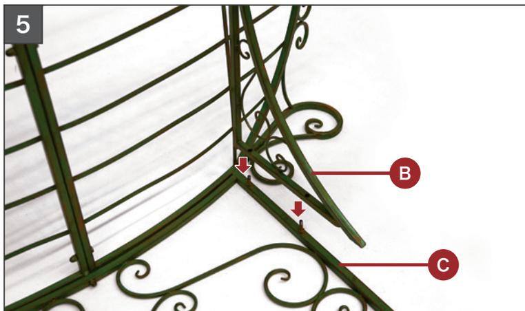
③の上から②を取り付けて、ボルトとナットで固定します。
