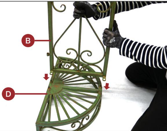
**D**の上から**B**を差し込み、ナットで固定します。
